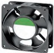
Ventilateur axial industriel. Puissance: 19W, tension de fonctionnement: 230V, bruit généré: 48dB, débit d'air: 177m<sup>3</sup>/h, Nombre de tours: 2900 t/min. Dimensions: 120x120x38mm.
