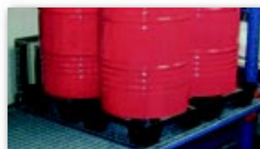
Bacs de rétention
